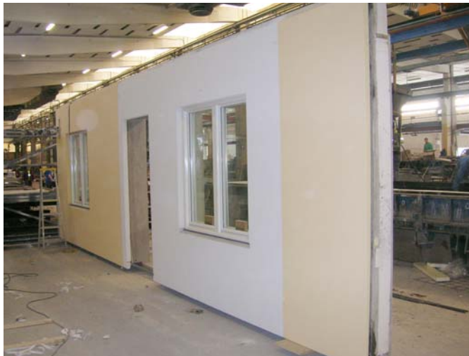
BILD 5.16 Icke bärande ytterväggs-element av fiberbetong med EPS-isolering.
