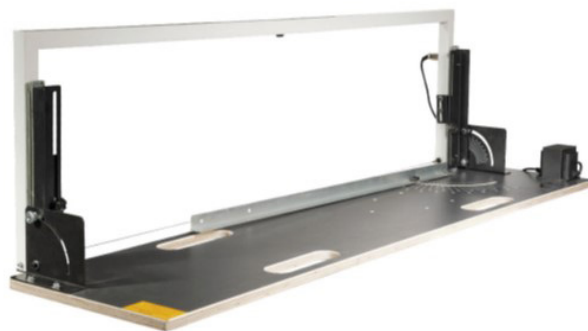
Varmekniv (glødetråd) med bord
