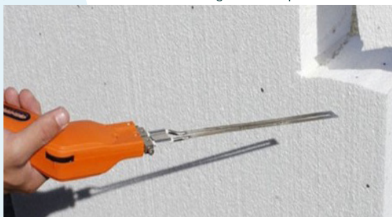
Håndholdt varmekniv til formskæring
